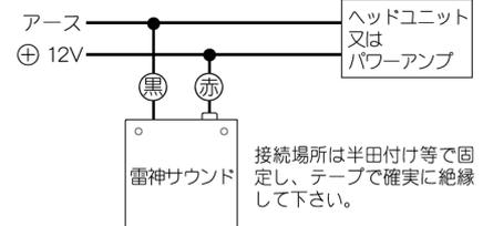
接続場所は半田付け等で固定し、テープで確実に絶縁して下さい。
