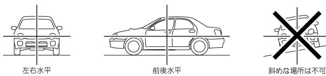
②車内の水平な場所でメーターの針が0~0.05G付近になる場所にセンサーを固定します。
